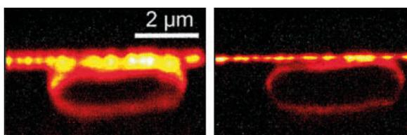
Figura 4. Uma das primeiras imagens obtidas por Stefan Hell com um microscópio STED. À esquerda, a imagem de uma bactéria *E. coli* obtida com um microscópio convencional; à direita, a imagem da mesma bactéria obtida com um microscópio STED. A resolução da imagem obtida com o microscópio STED é 3 vezes melhor. Imagem de Proc. Natl. Acad. Sci. USA 97: 8206–8210.
