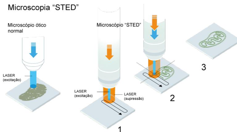
Figura 2. Num microscópio ótico convencional é possível observar os contornos de uma mitocôndria, mas sem detalhes da sua estrutura interna abaixo dos 0,2 micrometros. (1) Num microscópio “STED”, um feixe de laser anelar suprime toda a fluorescência fora de uma área nanométrica; (2) O laser faz o varrimento de toda a amostra e a imagem é construída ponto a ponto; (3) A imagem final tem uma resolução muito superior aos 0,2 micrometros.
