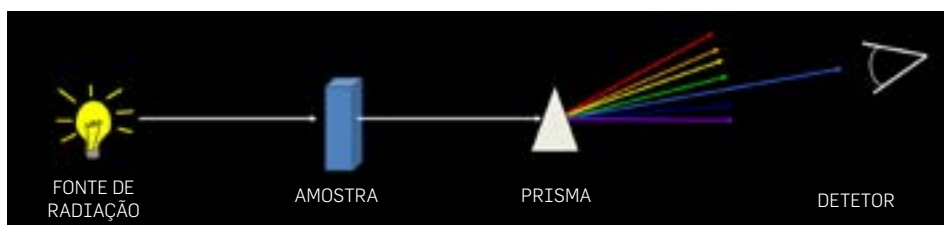
FIGURA 6A. Esquema simplificado de um espectrómetro de absorção: fonte de radiação, amostra, prisma (ou rede de difração) para dispersão da luz e detector.
