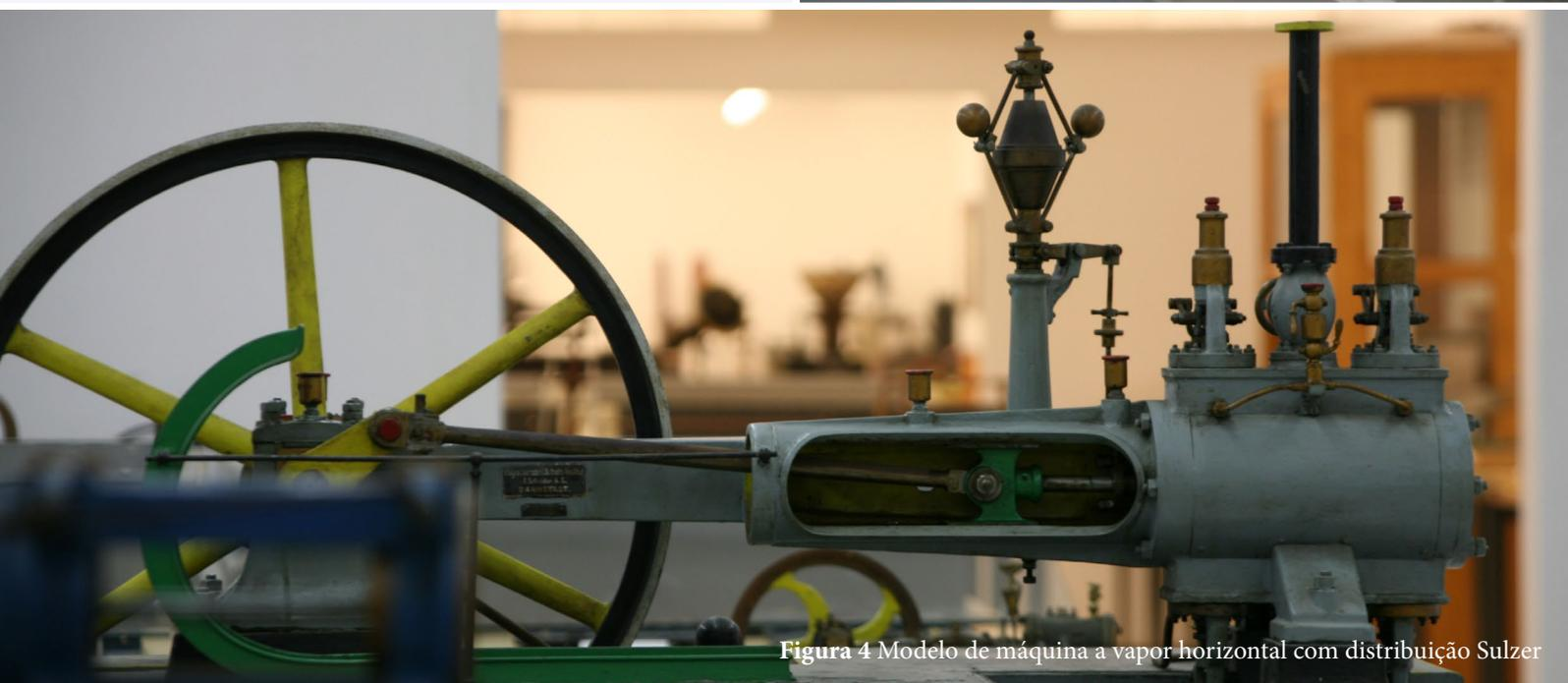
Figura 4 Modelo de máquina a vapor horizontal com distribuição Sulzer
