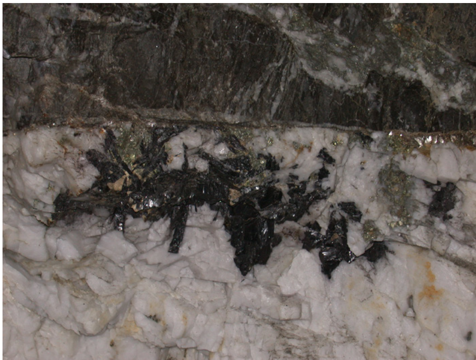
FIGURA 1. Filão do jazigo de volfrâmio da Panasqueira. Parte do filão em que pode ver-se quartzo (mineral branco), volframite (mineral preto), moscovite (mineral prateado brilhante) e pirite (mineral amarelado). Só a volframite é o mineral rico em W.
