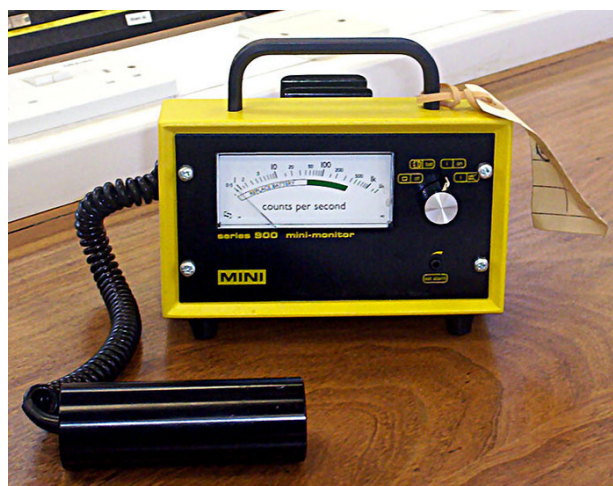
FIGURA 1. Contador de Geiger-Müller. 3
