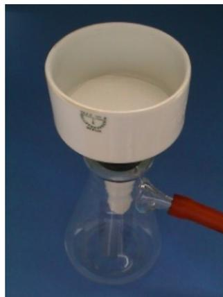
FIGURA 2. Conjunto de filtração Büchner.
