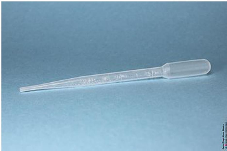
Figura 1. Pipeta de Pasteur.
