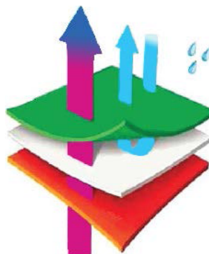
FIGURA 3. Esquema de funcionamento da membrana Gore-Tex®.
