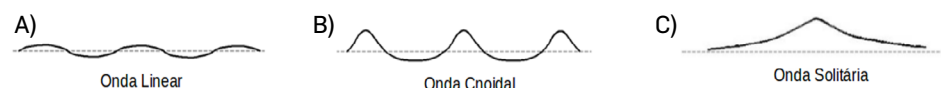
FIGURA 2. Representação gráfica de diferentes ondas a propagar-se segundo um dado eixo/direção: A) Onda Linear. B) Onda Cnoidal. C) Onda Solitária.
