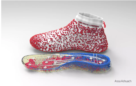
FIGURA 1. Sola com placa de circuito impressa em 3D, que contém sensores de recolha de dados. ( https://pt.euronews.com/next/2024/02/26/estes-sapatos-futuristas-impessos-em-3d-adaptam-se-aos-pes-e-poderao-chegar-ao-mercado-em ).
