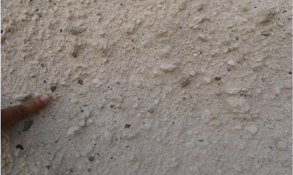
FIGURA 6. Aspeto macroscópico de ignimbrito, com partículas de origem vulcânica de diferente tamanho e de cor esbranquiçada (de composição dacítica a riolítica), que domina nas chaminés de fada.
